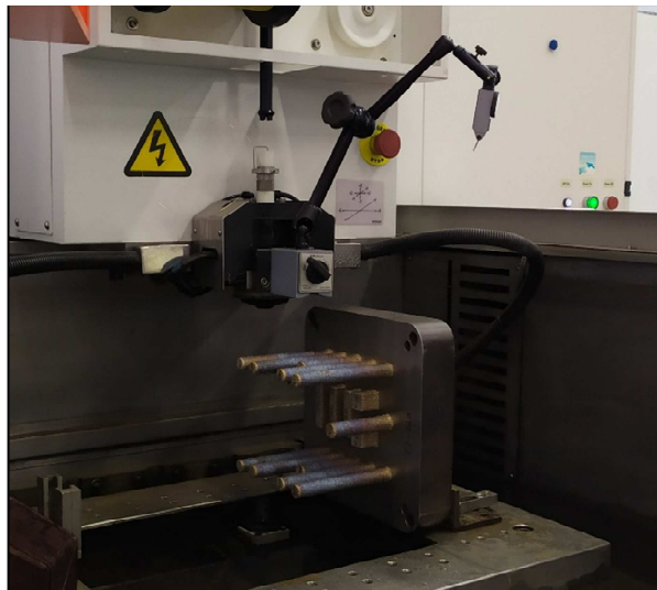
Figura 24 – Retirada dos corpos de prova do substrato pelo processo de eletroerosão a fio.
