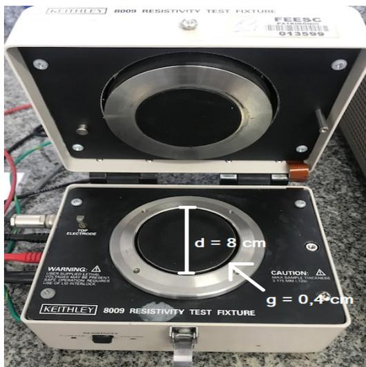
Figura 32 – Fotografia do dispositivo para medição da resistividade elétrica pelo método de 2 pontas.
