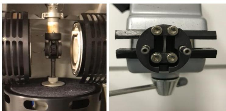
Figura 29 – Equipamento DMA/SDTA 861E, Mettler Toledo, durante o ensaio de DMA.
