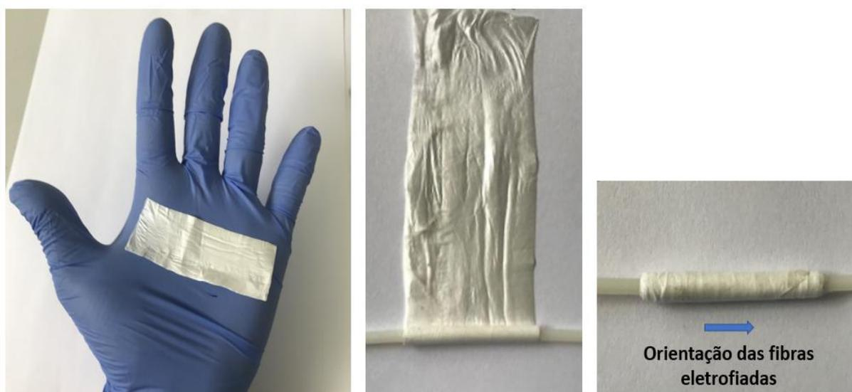
Figura 69 – Processo de obtenção do protótipo do conduíte eletrofiado, realizado previamente ao procedimento cirúrgico.
