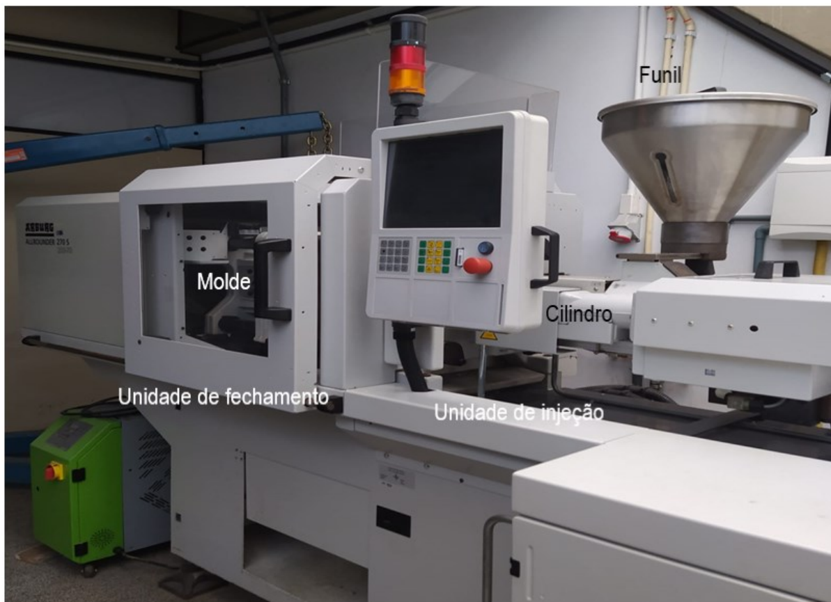
Figura 30 – Máquina de moldagem por injeção Arburg 270S 250-70 utilizada para a fabricação das peças.
