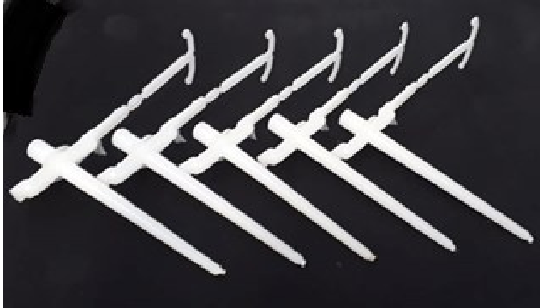
Figura 33 - DIUs com canal de alimentação moldados por injeção de PEAD/5-FU/PG em molde de alumínio.
