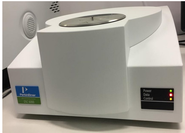
Figura 37 – Aparelho de calorimetria diferencial de varredura (DSC).
