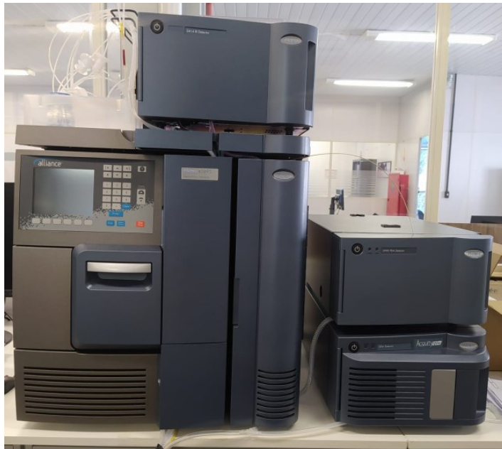
Figura 40 - Aparelho de cromatografia líquida de alta eficiência (HPLC – DAD) Waters Alliance e2695 ® .
