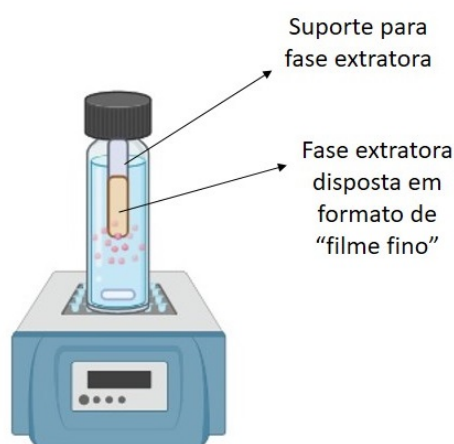
Figura 2 – Representação da extração através de TF-SPME.
