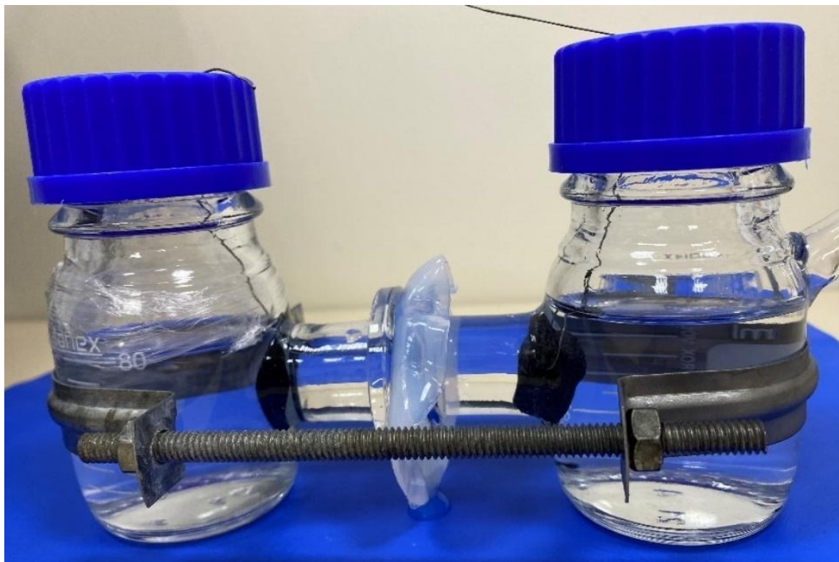
Figura 9 – Modelo de CCM montado para a avaliação do eletrodo anódico.
