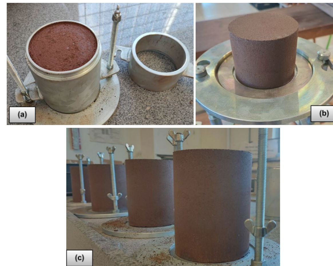
Figura 5: Amostras (a) moldadas no CBR, (b) extrator de CBR, (c) amostras aguardando tempo de cura para o ensaio de resistência mecânica.
