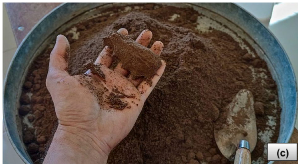
Figura 2: Mistura do solo-cimento: (a) solo com 10% de cimento, (b) mistura do solo-cimento seco e adição de água em uma mistura homogênea, e (c) solo-cimento pronto para moldagem das amostras.
