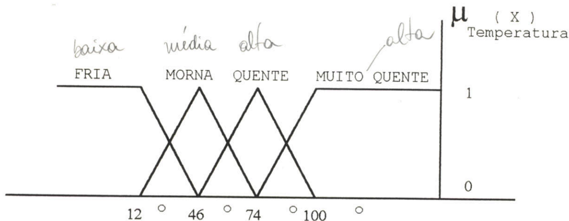
figura 3.3) Arranjo dos limites para um conjunto de sub-funções fuzzy da variável temperatura
