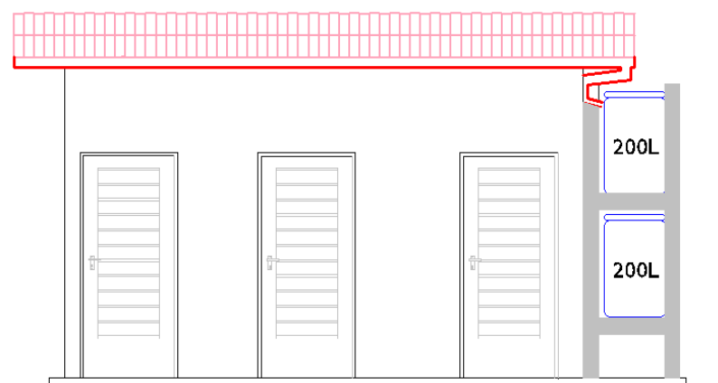
Figura 2: Esquema frontal das instalações que captam as águas do telhado do banheiro seco. Fonte: Elaborado pela equipe técnica responsável, 2017.
