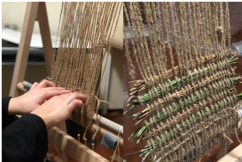
Figura 3 – Tecelagem de cânhamo com caruma verde e seca: a) Execução da peça; b) Padrão conseguido.
