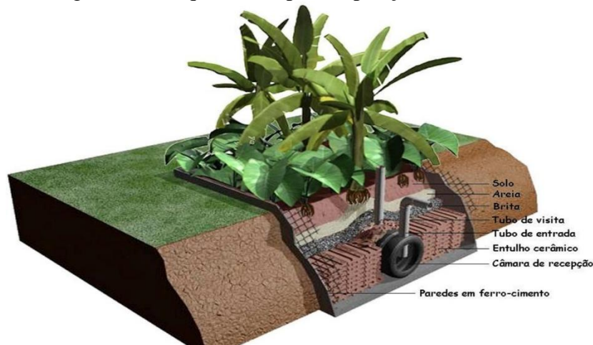
Figura 1 - Tanque de Evapotranspiração e suas camadas.
