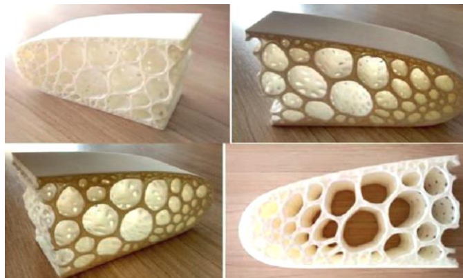
Figura 1 - Impressão 3D como exemplo de aplicação de uma estrutura bioinspirada nas estratégias de leveza e resistência do agave. (ARAÚJO, 2015). Fonte: Autores, (2015).
