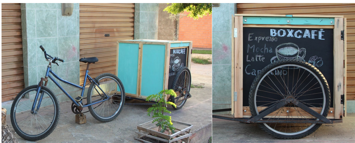
Figura 2: Protótipo desenvolvido em paletes. Fonte: elaborado pelos autores.
