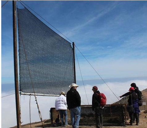
Figura 6: Atrapanieblas em Alto Patache no Chile. Fonte: Nicole Saffie - https://goo.gl/dEzP44
