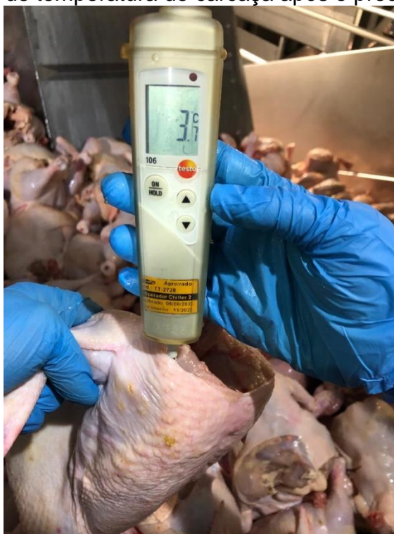
Figura 11 - Aferição de temperatura de carcaça após o processamento do chiller
