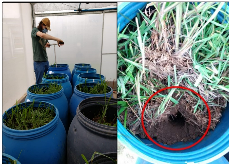
Figura 3: Registro da coleta de amostras no sistema Biobed . A) Momento de inserção do trado em uma réplica; B) Ponto de retirada da amostra destacado entre o círculo vermelho.
