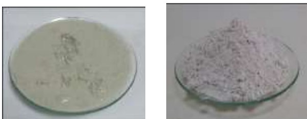
Figura 1 - Resíduo da lapidação de vidro (a) em forma de lodo e (b) em forma de pó. Fonte: elaborado pelos autores.
