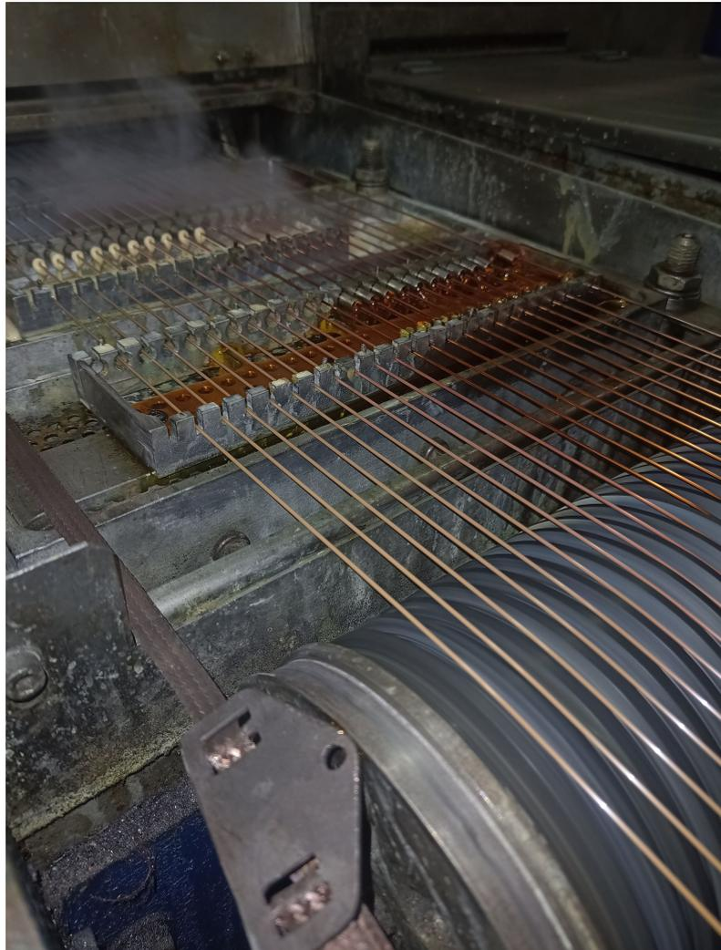
Então o fio passa pela etapa de secagem. Nele os fios com verniz já aplicados passam por fornos (figura 10) que retiram o solvente e curam o verniz selando-o no fio. Após passarem pelos fornos os fios se deslocam pela área de secagem a frio, onde o fio aberto ao ambiente é resfriado com diversos exaustores retirando o vapor dos fios e circulando ar, facilitando a secagem (figura 8).
