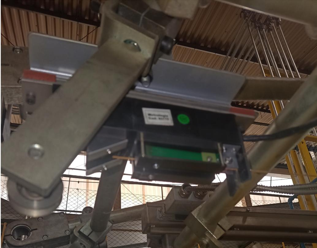
Por fim o fio vai para a última máquina que enrola o fio no carretel. Essa máquina é interessante pois quando um carretel é completo não é necessário parar a produção, a máquina troca de carretel automaticamente, cabendo ao colaborador apenas mover o carretel cheio para o local adequado.
