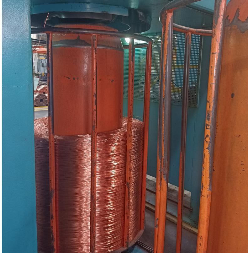
No segunda trefilagem o fio grosso passa por diversas roldanas sendo devidamente lubrificado até alcançar o diâmetro requerido pelo lote solicitado pelos consumidores das outras fábricas da empresa.
