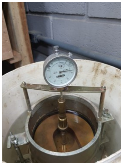
Figura 14 - Corpo de prova embebido em água
