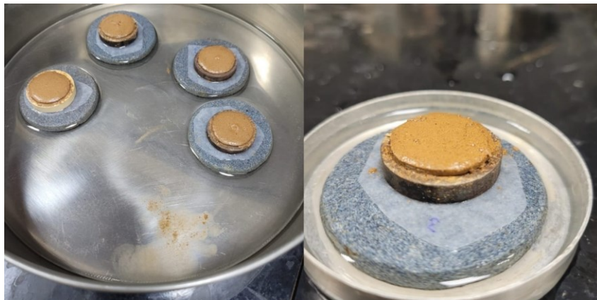
Figura 13 - Pastilhas submetidas a saturação
