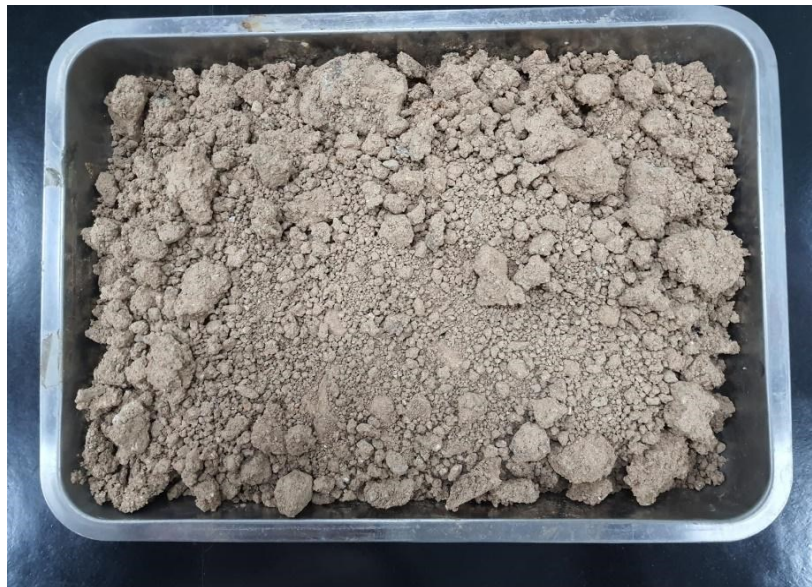
Figura 12 - Amostra de solo após seco em estufa
