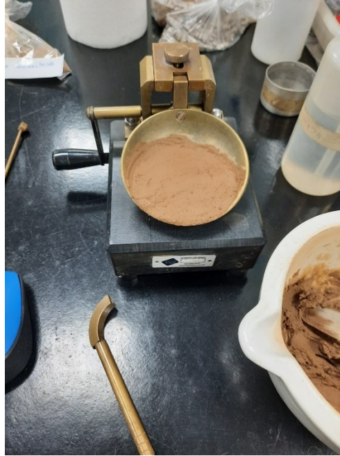
Figura 24 Aparelho de Casagrande com a amostra de solo.
