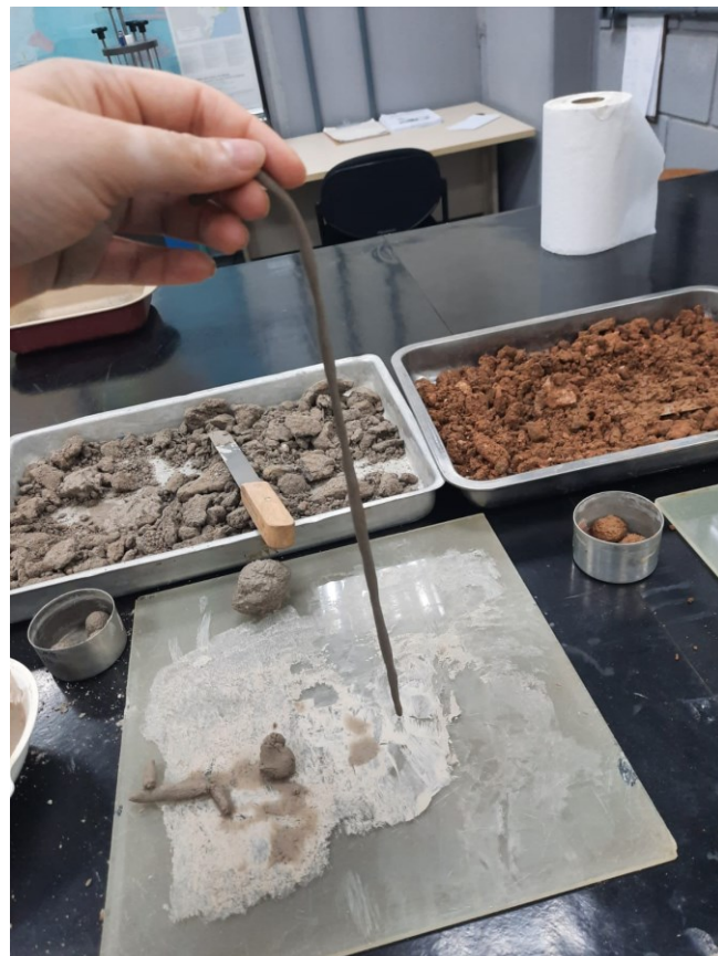
Figura 39 Solo Superficial e Solo Profundo Moldagem de Bastonete
