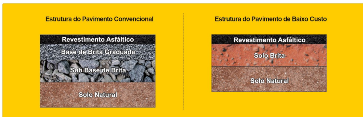
Figura 4 Comparação entre as estruturas do pavimento
