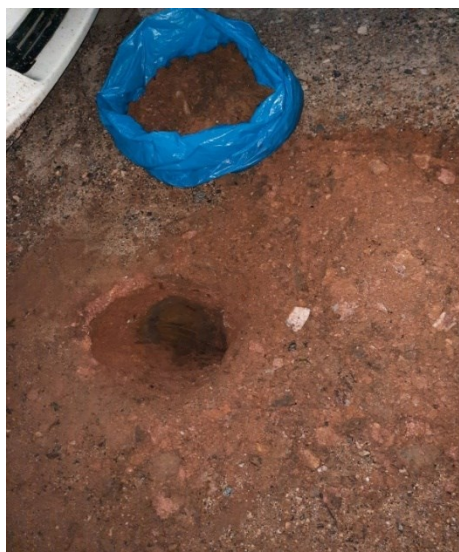
Figura 19 Extração da amostra de solo.
