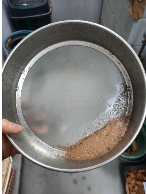
Figura 22 Material retido na peneira de 0,075mm.
