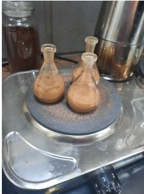
Figura 25 Picnômetro com as amostras de solo sendo aquecidas.
