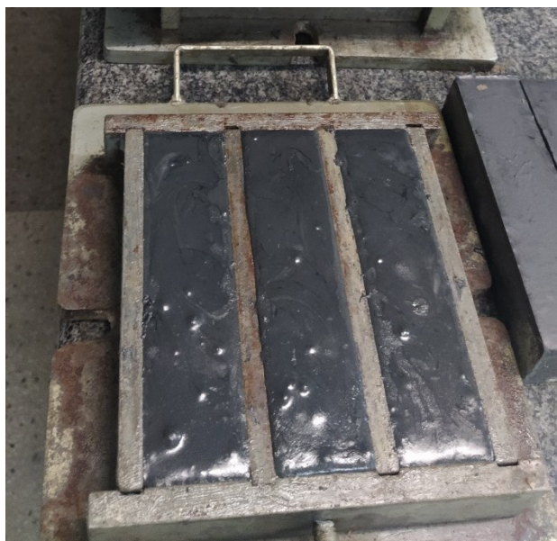
Figura 16 – Corpos de prova prismáticos no estado fresco
