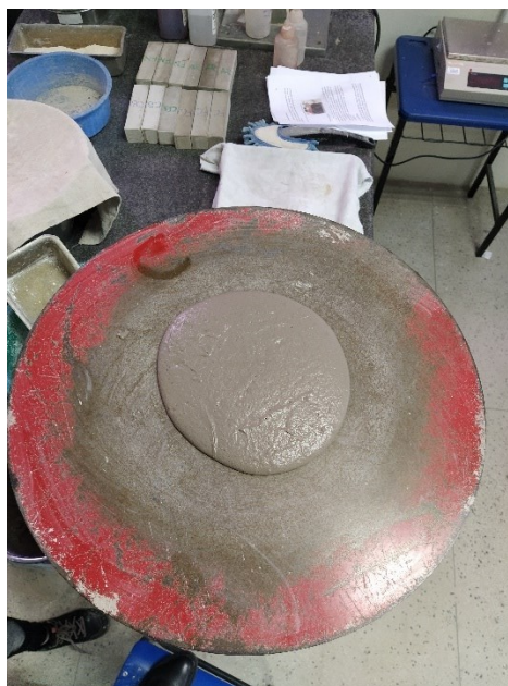
Figura 17 – Ensaio de Índice de Consistência.
