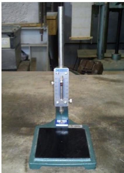
Figura 18 – Aparelho de Vicat para a realização do ensaio de tempo de pega.
