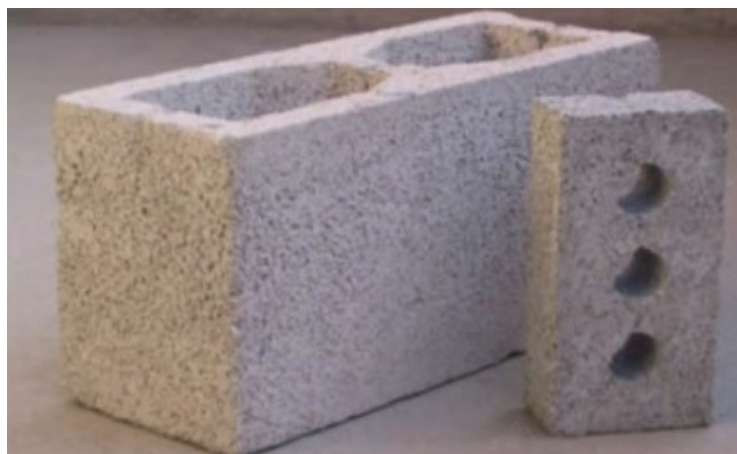
Figura 3 – Aplicação de geopolímero em bloco refratário.
