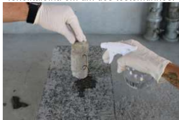
Figura 33 - Aspersão da solução de fenolftaleína em um dos testemunhos.
