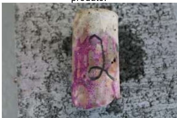
Figura 34 - Mudança na coloração do corpo de prova após aspersão do produto.
