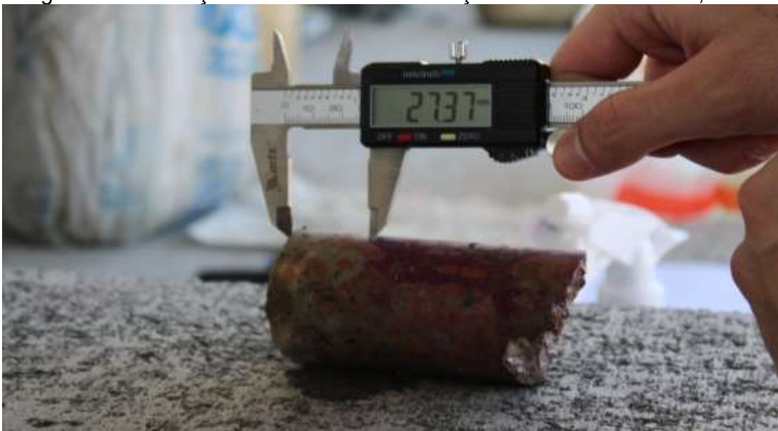
Figura 114 – Aferição da frente de carbonatação. Resultado obtido: 2,7 cm.
