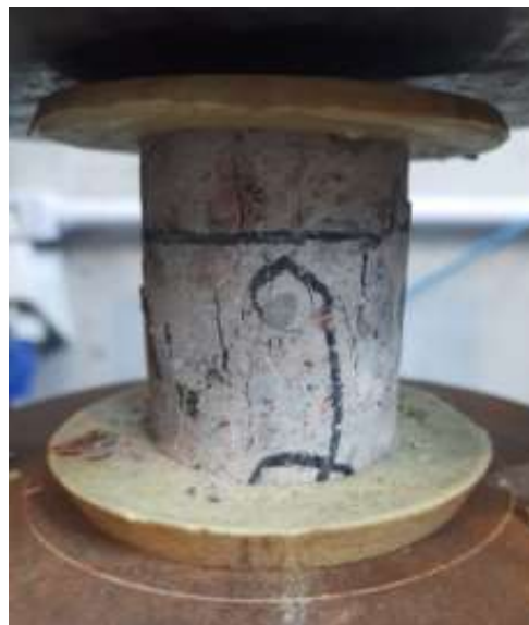
Figura 31 - Realização do rompimento de um dos 4 minitestemunhos extraídos.
