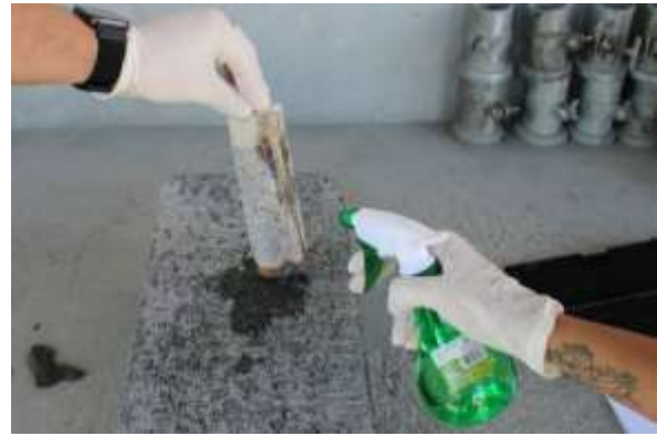
Figura 37 - Aspersão do nitrato de prata em um dos testemunhos.
