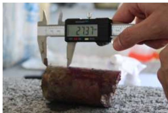
Figura 35 - Medição da frente de carbonatação com paquímetro digital.
