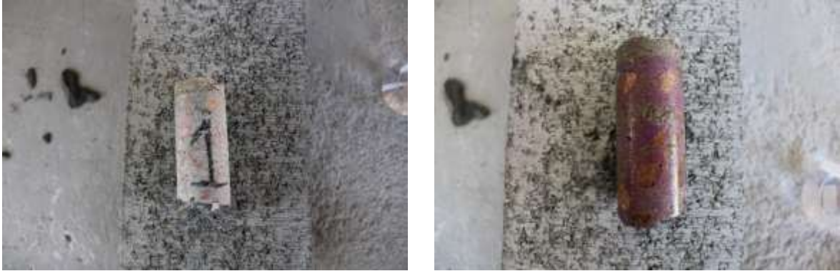
Figura 112 – Resultado de ensaio de carbonatação no CP1 indicando concreto sadio (Rosa púrpura), a região carbonatada trata-se de revestimento argamassado.
