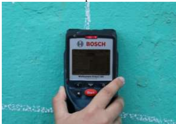
Figura 26 - Utilização do pacômetro para obtenção da posição das barras de aço.
