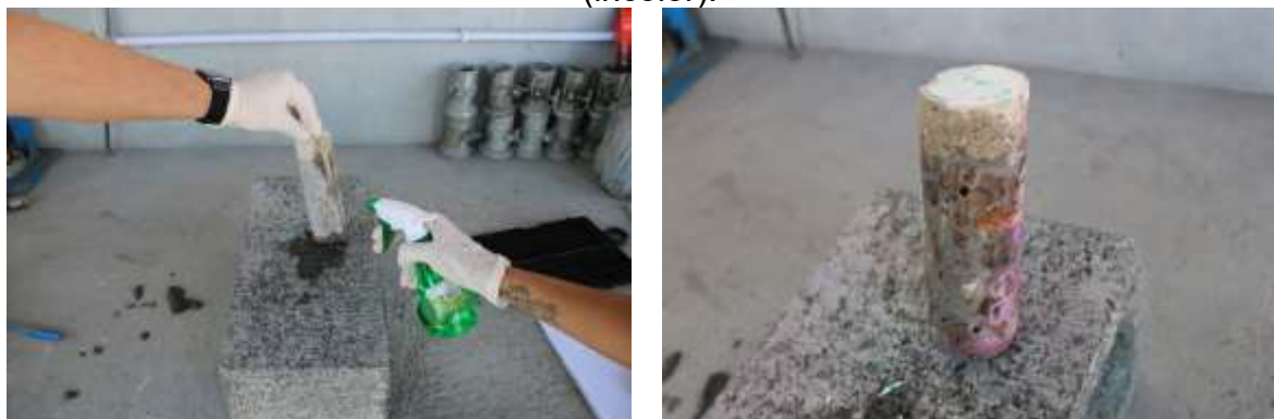
Figura 117 - Resultado de ensaio de íons cloreto no CP 3, indicando concreto sadio (incolor).
