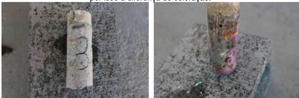
Figura 115 – Resultado de ensaio de carbonatação no CP3 indicando a presença de um concreto sadio. Ressalta-se que na região incolor foi aplicado o nitrato de prata, por isso a diferença de coloração.
