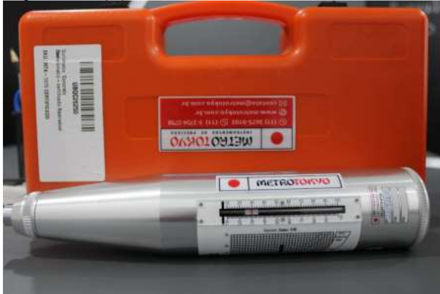
Figura 20 - Equipamento utilizado no ensaio de esclerometria.
