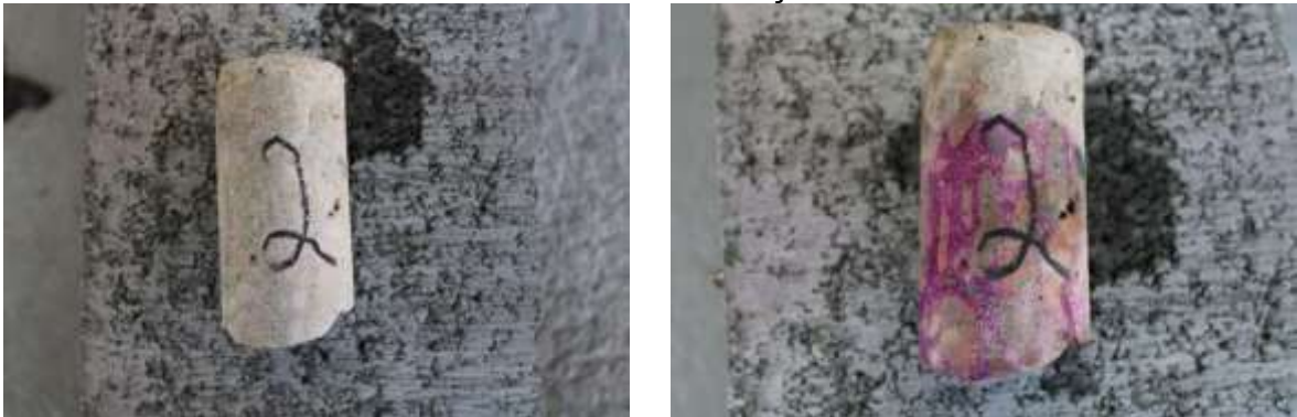
Figura 113 - Resultado de ensaio de carbonatação no CP indicando em sua grande maioria concreto sadio (rosa púrpura), presença de aproximadamente 2,7 cm de frente de carbonatação.
