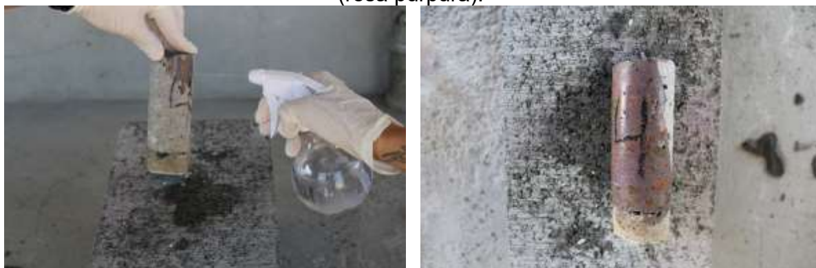
Figura 116 - Resultado de ensaio de carbonatação no CP4 indicando concreto sadio (rosa púrpura).
