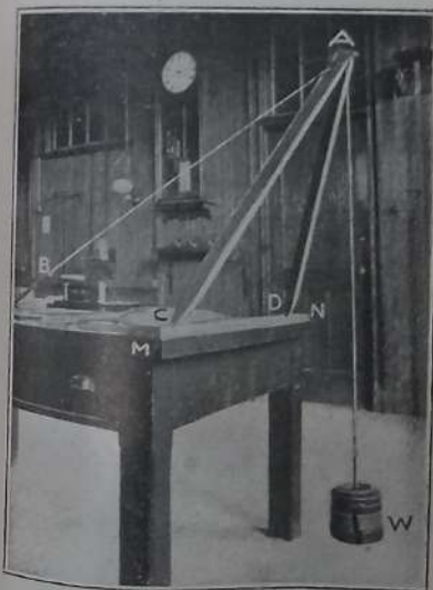
Apparelho para demonstrar em aula os esforços exercidos num guindaste
