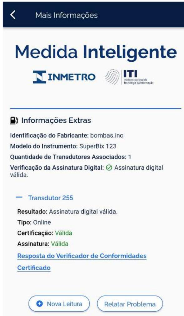
Figura 9: Painéis expansíveis que revelam informações adicionais sobre os transdutores utilizados na operação de abastecimento.
