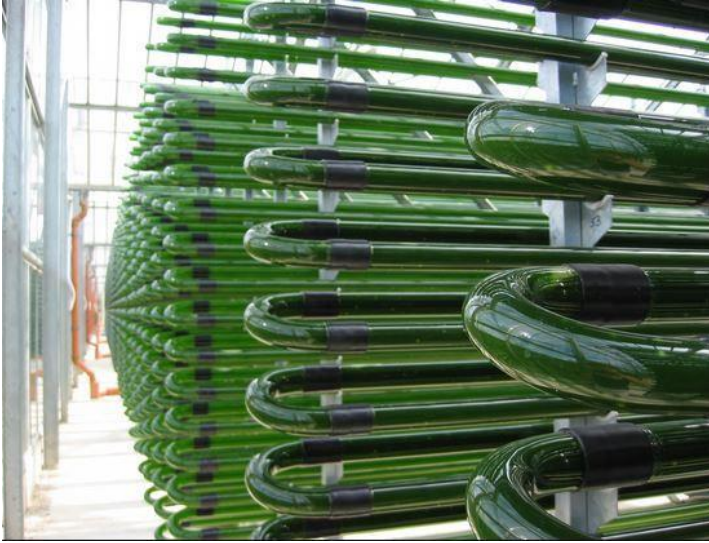
Figura 2 - Fotobiorreator Tubular, Algomed (Alemanha).
