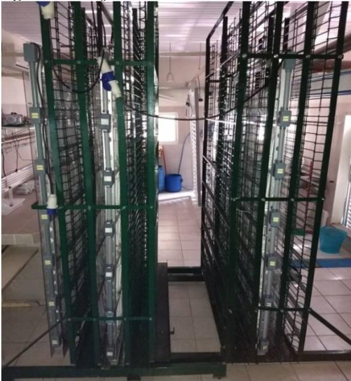
Figura 6 - Conjunto de FBR-FP instalados.
