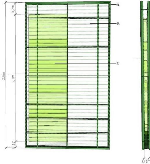
Figura 5 - Desenho estrutural de um dos FBR-FP.
