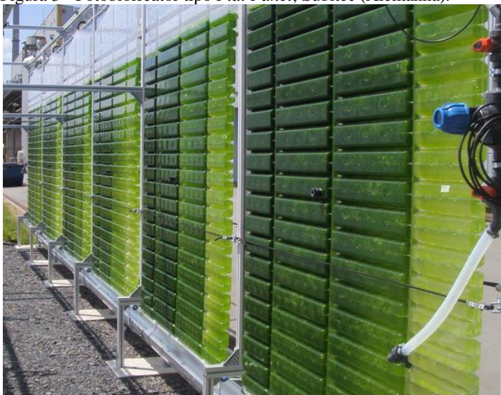
Figura 3 - Fotobiorreator tipo Flat Panel , Subitec (Alemanha).
