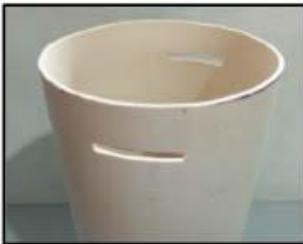
**2º passo:** No cano de PVC faça uma abertura de um lado ao outro, suficiente para entrar e sair a haste, a uma distância de 2 cm do topo do cano.
