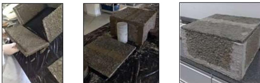
**Figura 4 – Montagem da caixa produzida a partir das placas EVA/cimento. Fonte: elaborado pelos autores.**
