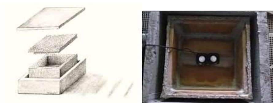
**Figura 5 – Sistema caixa EVA/cimento dentro da caixa de concreto com som MP3 dentro. Fonte: elaborado pelos autores.**
