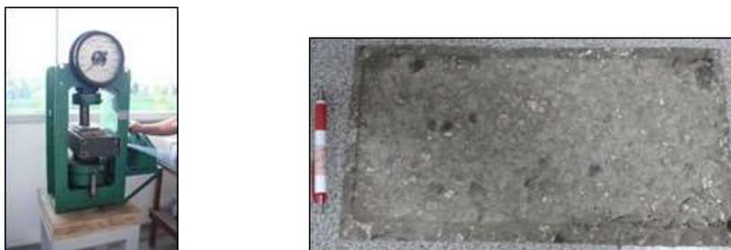
**Figura 3 - Aplicação de 5 toneladas e placa pronta após 24 horas. Fonte: elaborado pelos autores.**
