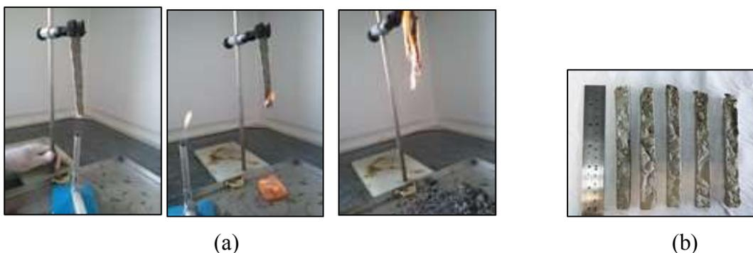
**Figura 10 – Ensaio de queima vertical das amostras de EVA/cimento (a) sem ATH e (b) com ATH.**
