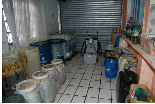
Figura 6 – Local onde é feita a reciclagem do óleo (unidade de tratamento). Ao fundo, máquina de filtragem do óleo doada pela Fundação AVINA.
