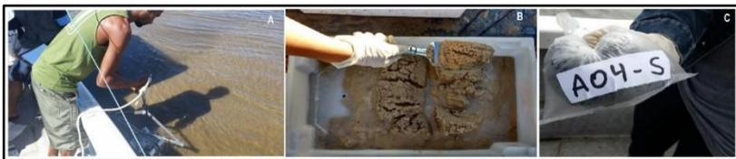
À bordo, a localização geográfica e as características texturais de cada amostra foram anotadas para facilitar o reconhecimento em laboratório. As amostras coletadas foram acondicionadas em sacos plásticos, datadas, etiquetadas e armazenadas no Laboratório de Oceanografia Geológica da UESC. A Figura 17 e o Quadro 1 mostram a distribuição da malha de pontos de coleta e as informações geográficas e profundidade das amostras superficiais do fundo estuarino na baía do Pontal.
