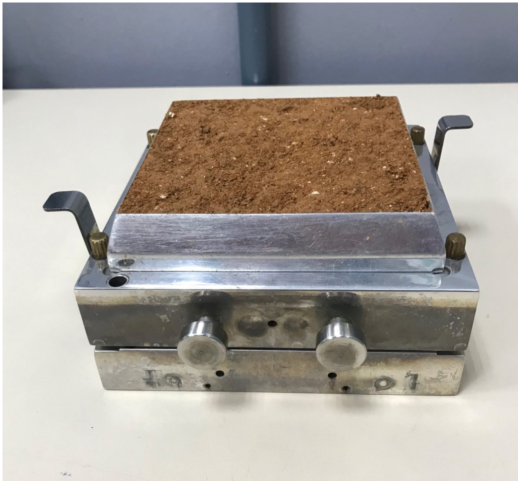
Figura 41 – Corpo de prova de solo residual para ensaio de cisalhamento direto
