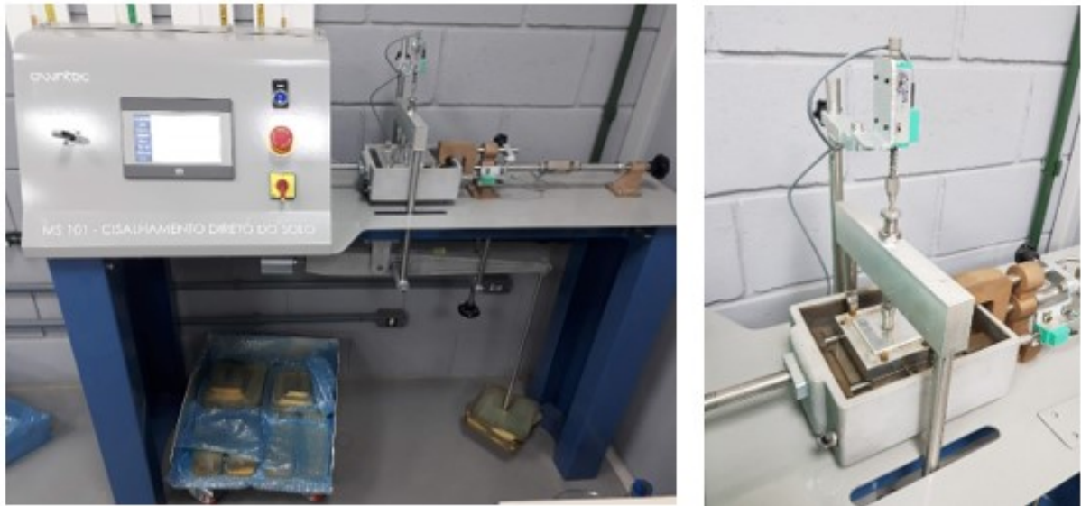
Figura 40 – Equipamento de ensaio de cisalhamento direto
