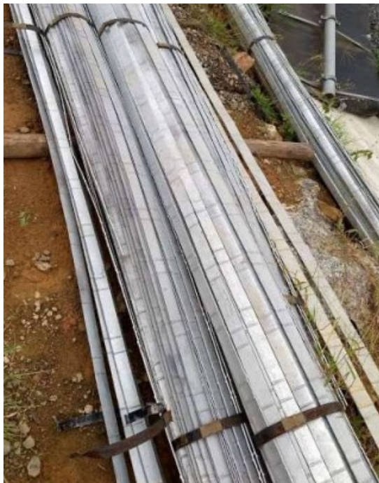
Figura 12 – Fita metálica usada em sistemas de contenção
