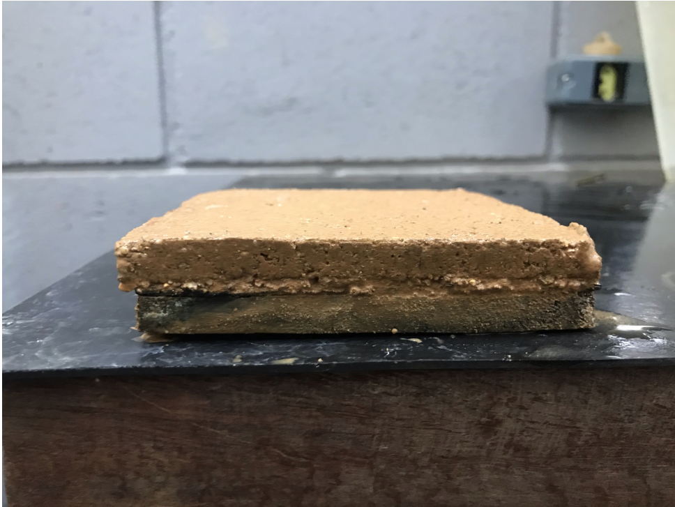
Figura 43 – Amostra após ensaio de cisalhamento
