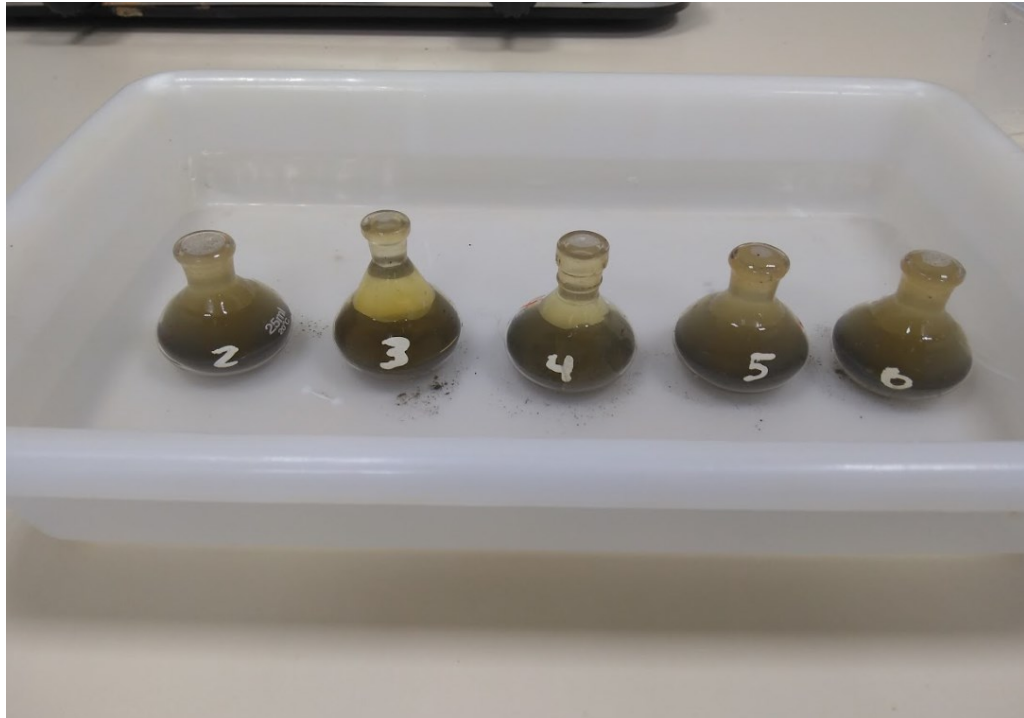
Imagem 9 – Ensaio do Picnômetro.
