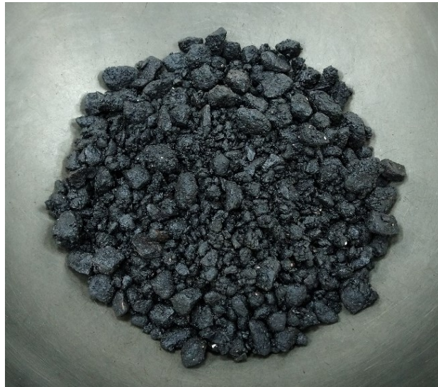
Figura 3.8 - Amostra preparada para o ensaio de MVR.
