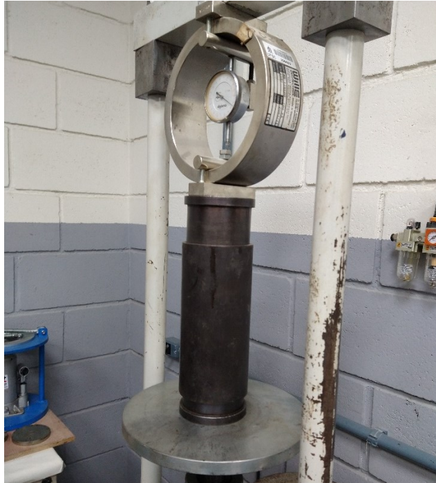
Figura 3.18 - Compactação dos corpos de prova por duplo pistão no ensaio de Duriez.
