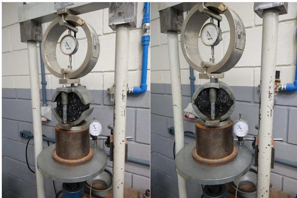
Figura 3.14 - Procedimento de ruptura dos corpos de prova.
