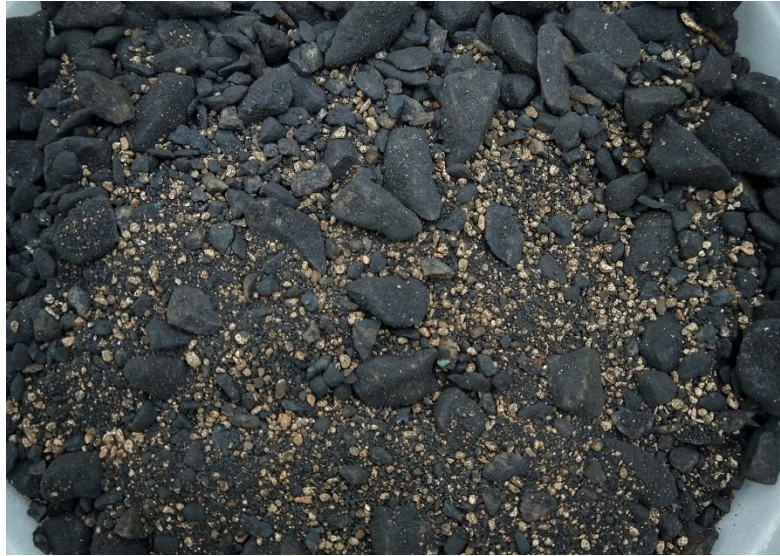
Figura 3.9 - Amostra do ensaio de MVR com 30,0 % de RCD e teor de ligante em 4,54 %.
