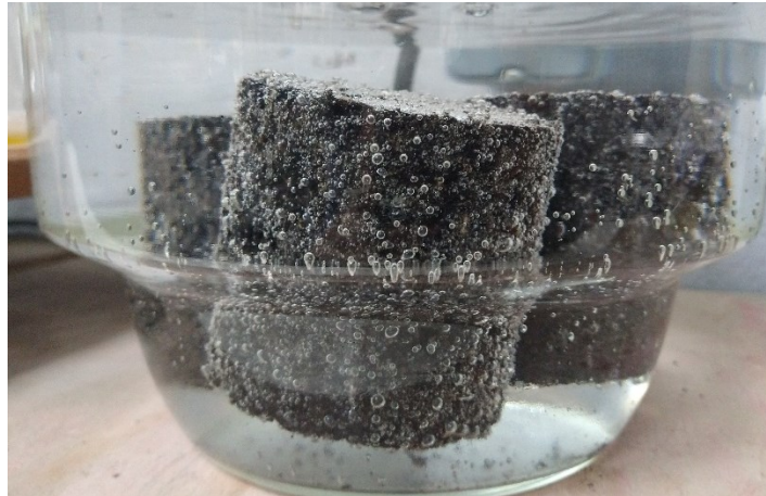
Figura 3.19- Saturação das amostras no ensaio de Duriez.
