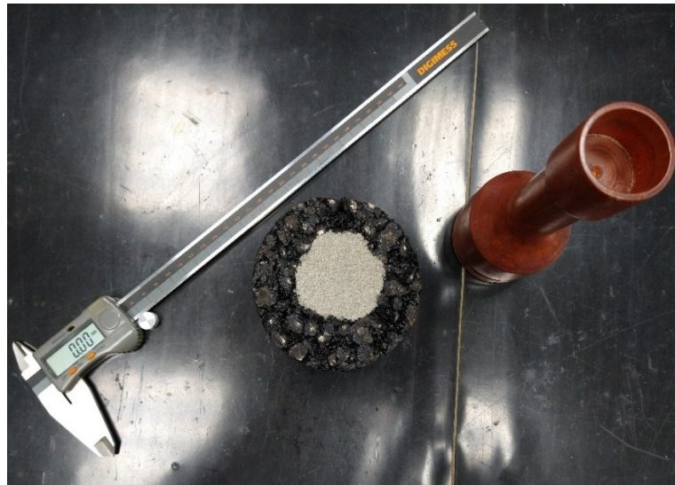
Figura 3.15 - Conjunto para execução do ensaio de mancha de areia.
