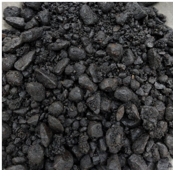
Figura 3.10 - Amostra do ensaio de MVR com 30,0 % de RCD e teor de ligante em 6,14 %.
