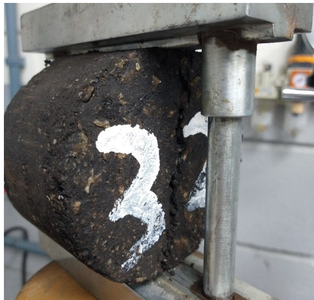
Figura 3.17 - Ruptura de um corpo de prova à tração indireta.
