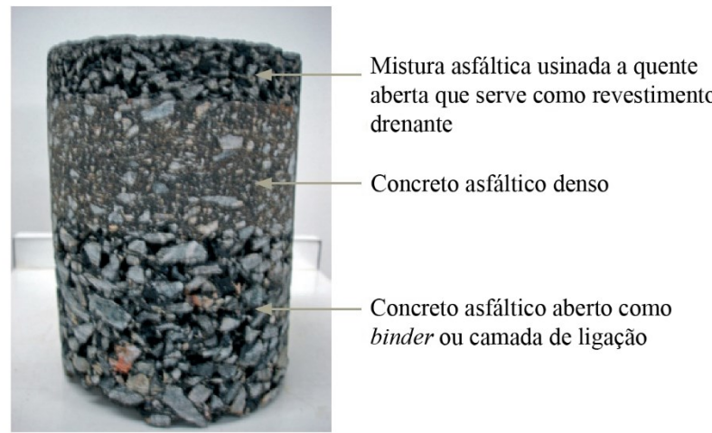
Figura 2.2 - Corpo de prova extraído de uma estrutura de pavimento ilustrando várias composições.
