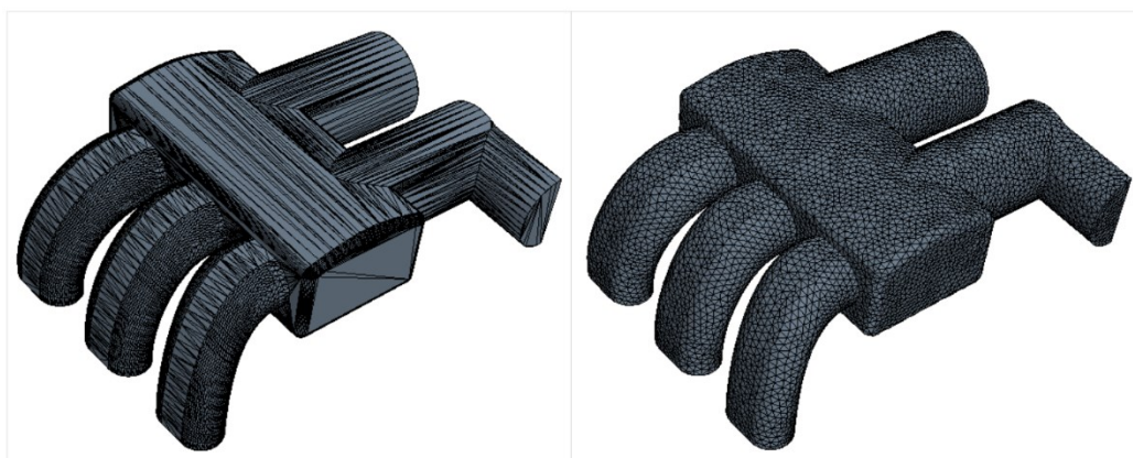
Figura 20 – Exemplo do antes e depois da utilização do retificador de superfície na geração de malha, respectivamente
