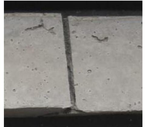
Nas argamassas 100C e 50C50S, antes do rompimento total dos corpos de prova, houve deformação. Já na argamassa 50C50Cv houve o rompimento do corpo de prova sem deformação.
