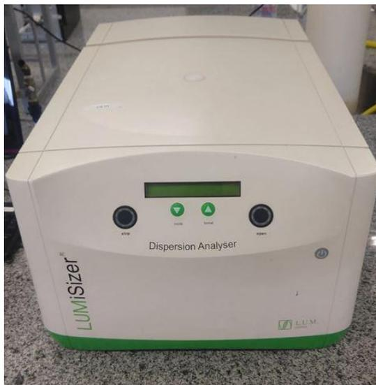
O ensaio consiste em submeter as amostras à aceleração centrípeta, forçando as partículas dispersas a se aglomerarem na extremidade do porta amostra. O porta amostra fica localizado entre uma fonte de luz e um receptor. Conforme as partículas se movimentam e se acumulam, a passagem de luz através da amostra aumenta. Dessa forma, é possível obter a velocidade de sedimentação das partículas.
