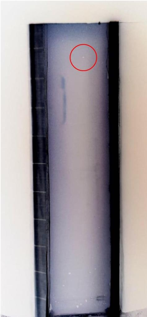
(b) Aspecto da argamassa com cinza volante 72 horas após o preparo.
