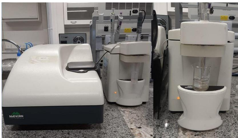
O potencial zeta foi medido na faixa de pH entre 2 e 12. Para a titulação das amostras foi utilizado hidróxido de sódio (1M) e ácido clorídrico (0,5M).
