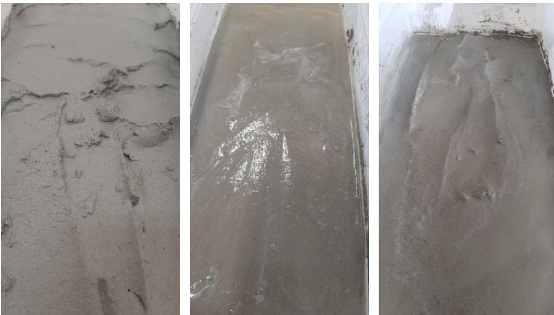
A argamassa com cinza volante 50C50Cv não apresentou sinais de exsudação 24 horas após a mistura (Figura 36a). Após 48 horas (Figura 36b), notou-se a presença de uma camada de água na superfície da argamassa 50C50Cv. Ao final da estabilização (Figura 36c, percebe-se que há uma diminuição na quantidade de água presente na superfície do material com relação ao observado em 48 horas.
