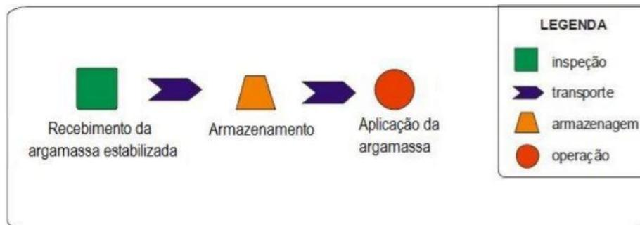
Há muitas vantagens em substituir a argamassa misturada em obra pela argamassa estabilizada, como por exemplo o aumento da produtividade do canteiro de obra, o aumento da precisão, a regularidade quanto a dosagem dos aditivos e a diminuição da insalubridade no manuseio de cimento e cal em pó na obra, etc [BAUER et al. 2015]. As principais propriedades para uma argamassa estabilizada são, entre outras, a boa trabalhabilidade, resistência mecânica uniforme, baixo risco de fissuração, etc.
