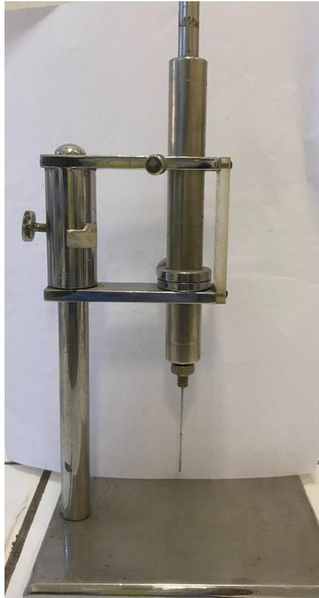
Os tempos de início e fim de pega mensurados foram utilizados como parâmetros na etapa do estudo em argamassas, para datas de desmoldagem dos corpos de prova e realização de ensaios.
