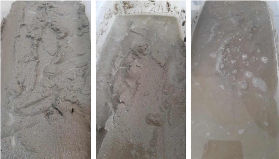
A argamassa com sílica apresentou sinais de exsudação 24 após a mistura (Figura 35a). Nota-se que a quantidade de água acumulada na superfície da argamassa fresca aumenta significativamente ao longo do período de estabilização. Com 72 horas após o preparo (Figura 35c) há uma camada de água cobrindo toda a superfície da argamassa.
