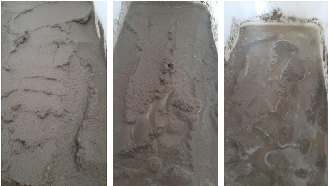
A argamassa 100C não apresentou água em sua superfície 24 horas após a mistura (Figura 34a). Após 48 horas (Figura 34b), pode-se observar uma pequena quantidade de água exsudada. Ao final da estabilização, em 72 horas (Figura 34c), a argamassa 100C apresentou quantidade considerável de água exsudada.
