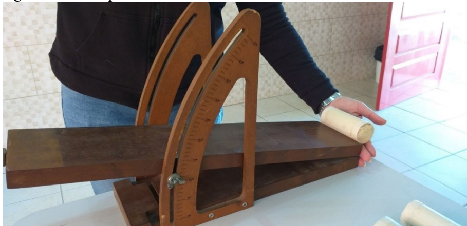
Figura 41 - Rampa de madeira com o fim do rolamento do tubo de PVC
