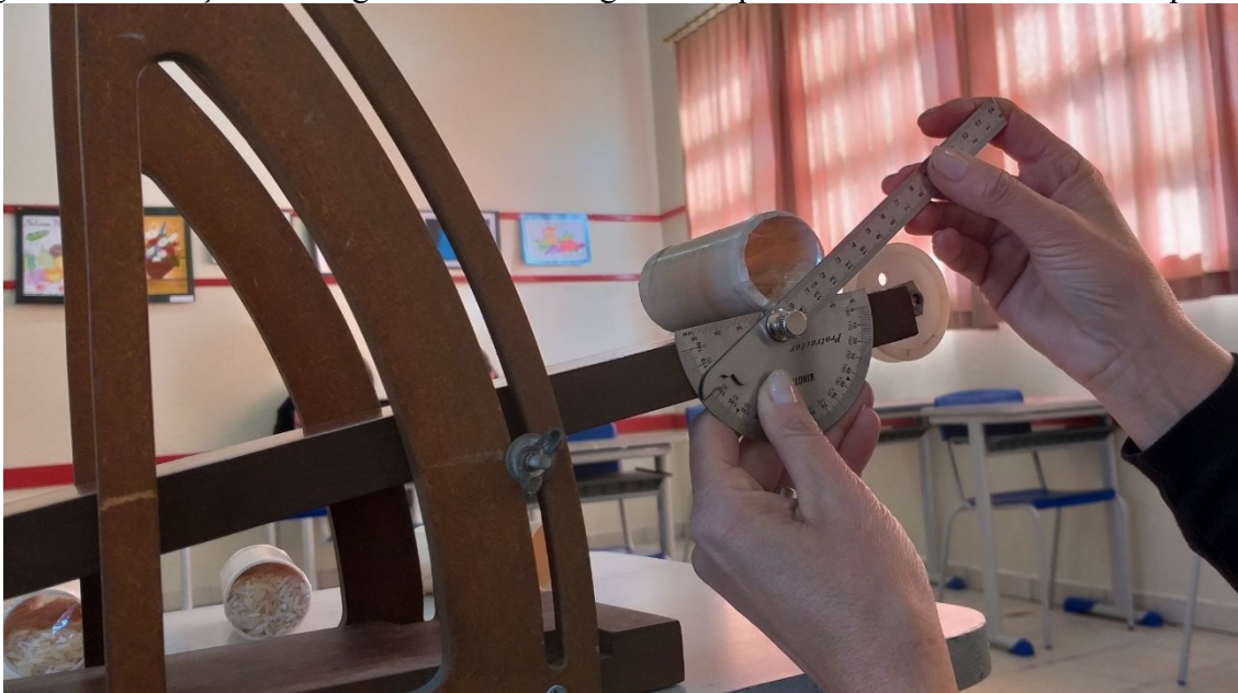
Figura 43 - Medição com o goniômetro do ângulo de equilíbrio do tubo de PVC em equilíbrio
