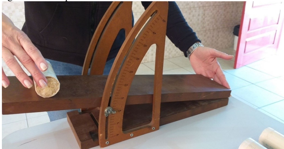
Figura 40 - Rampa de madeira com início do rolamento do tubo de PVC
