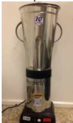
Figura 10. Liquidificador industrial utilizado para o preparo dos resíduos utilizados no ensaio de caracterização da fase acidogênica.
