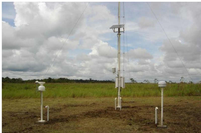
Figura 30- Exemplo de estação meteorológica automática.
