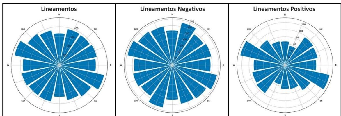
Figura 44 – Diagramas de roseta mostrando as principais direções dos lineamentos identificados na área de estudo. Fonte: Elaborado pelo autor.
