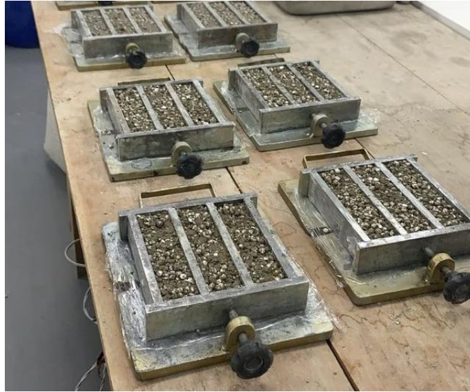
Figura 11 – Moldagem dos corpos-de-prova.
