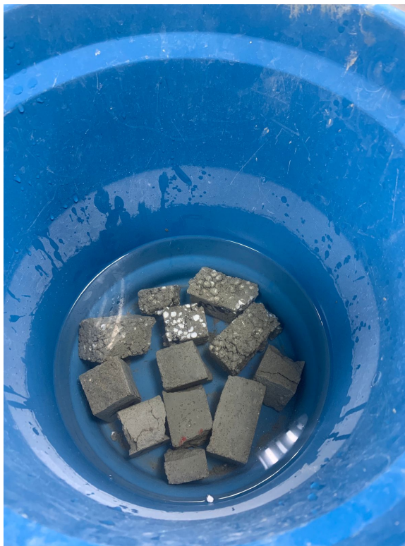
Figura 15 – Amostras em imersão por 72 horas.
