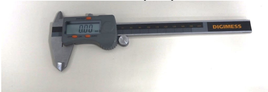
Figura 19 – Paquímetro digital utilizado para conferência do comprimento e diâmetros dos corpos de prova
