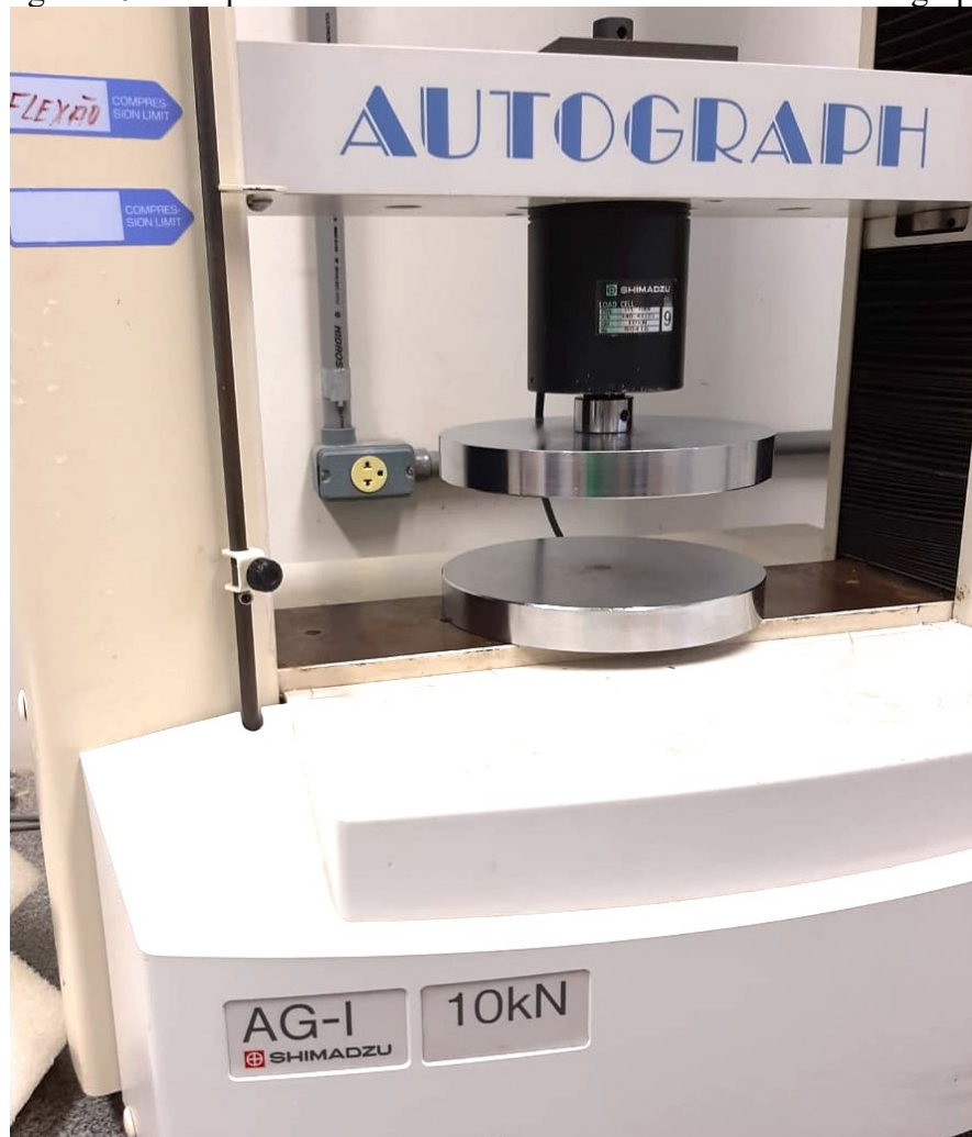
Figura 20 – Máquina de ensaios universais Shimadzu AG-I Autograph
