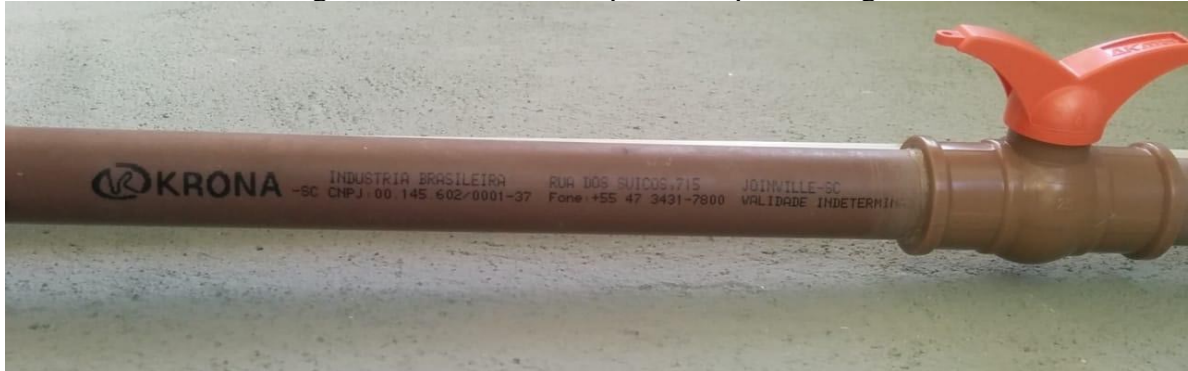
Figura 4 – Tubo de PVC para transporte de água
