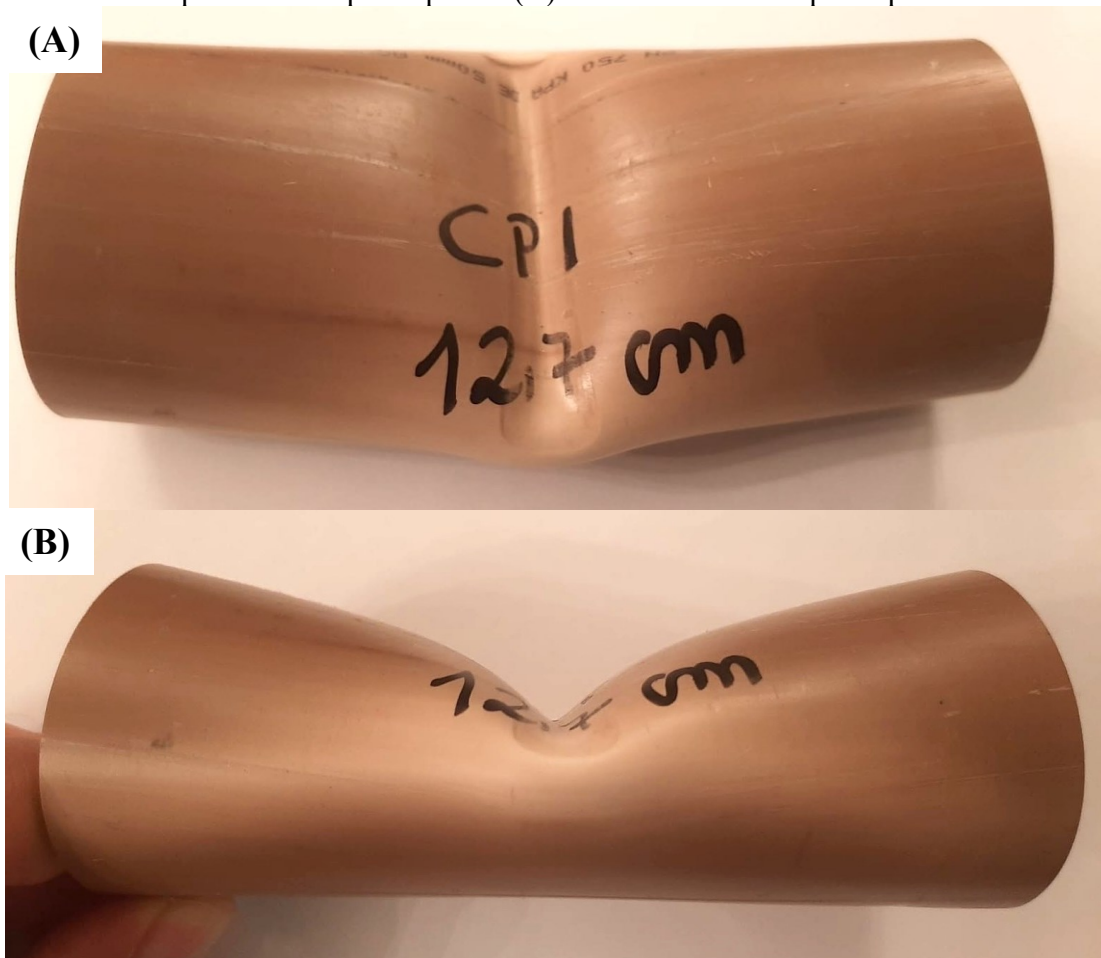
Figura 28 – Corpo de prova após 22 dias de ensaio de flexão por três pontos. (A) Vista superior do corpo de prova. (B) Vista lateral do corpo de prova
