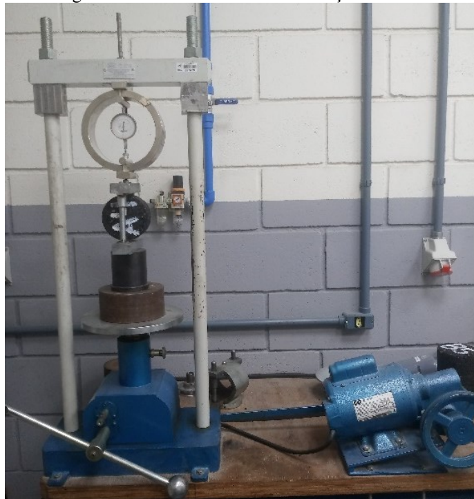
Figura 27 - Ensaio de resistência à tração indireta.
