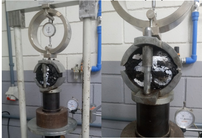
Figura 25 - Procedimento de ruptura do corpo de prova.
