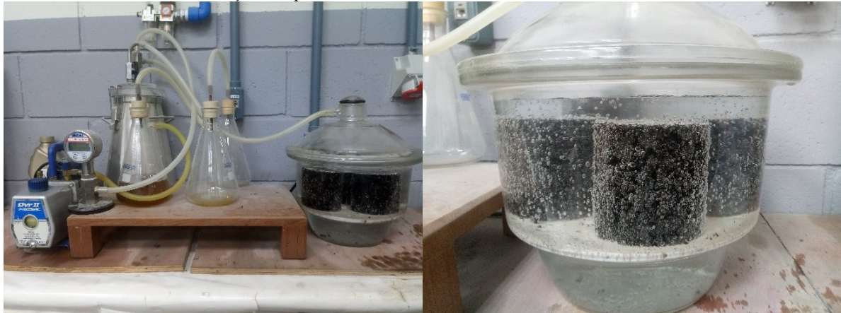
Figura 33 - Saturação dos corpos de prova condicionados por imersão: (a) sistema de bomba de vácuo; (b) remoção das partículas de ar contidos nos vazios da mistura.
