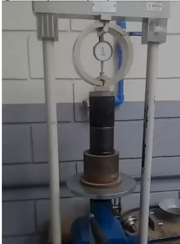
Figura 34 - Ruptura do corpo de prova no ensaio Duriez.
