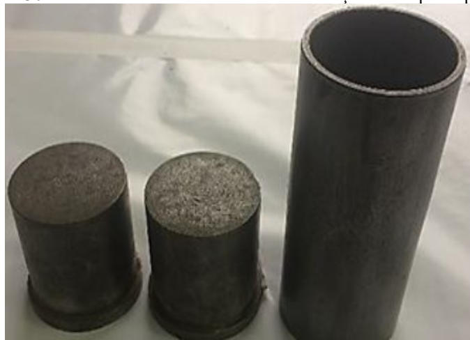
Figura 30 - Molde e êmbolos utilizados na confecção do corpo de prova.
