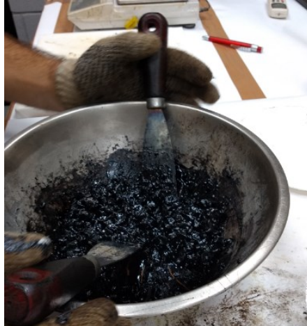
Figura 17 - Procedimento de mistura dos materiais no processo de usinagem.
