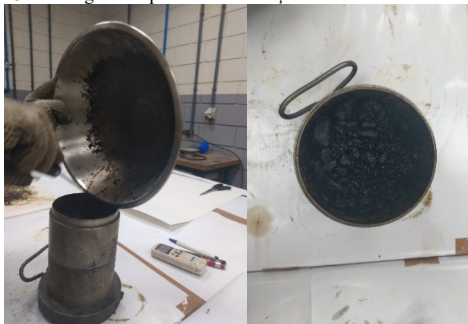
Figura 18 - Visão geral do processo de inserção da mistura asfáltica no molde.
