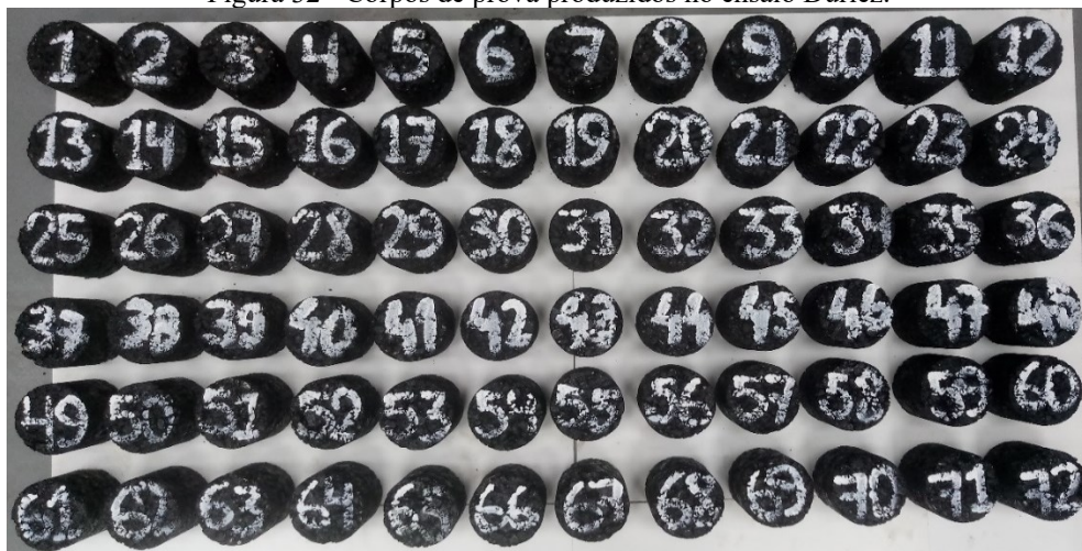
Figura 32 - Corpos de prova produzidos no ensaio Duriez.
