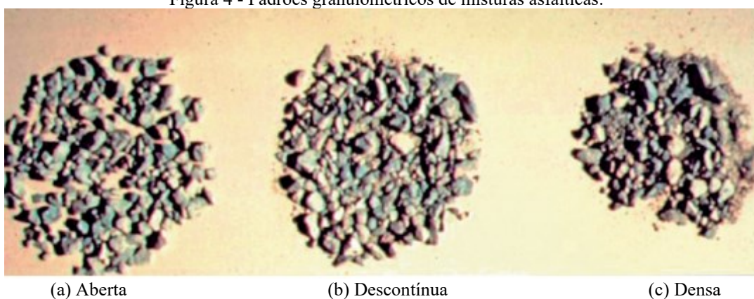
Figura 4 - Padrões granulométricos de misturas asfálticas.
