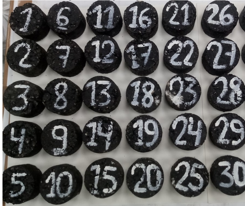
Figura 21 - Corpos de prova Marshall.
