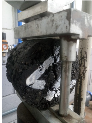
Figura 28 - Ruptura no plano diametral vertical.
