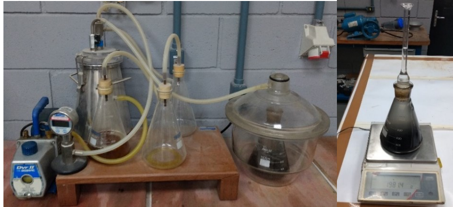
Figura 16 - Sistema de vácuo com o conjunto da amostra e picnômetro: (a) bomba de vácuo, (b) pesagem da amostra.
