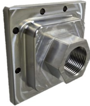
Figura 13. Fotografia dos bocais usinados em alumínio.
