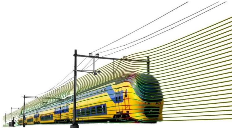
Figura 7 - Fluxo de ar sobre trem.
