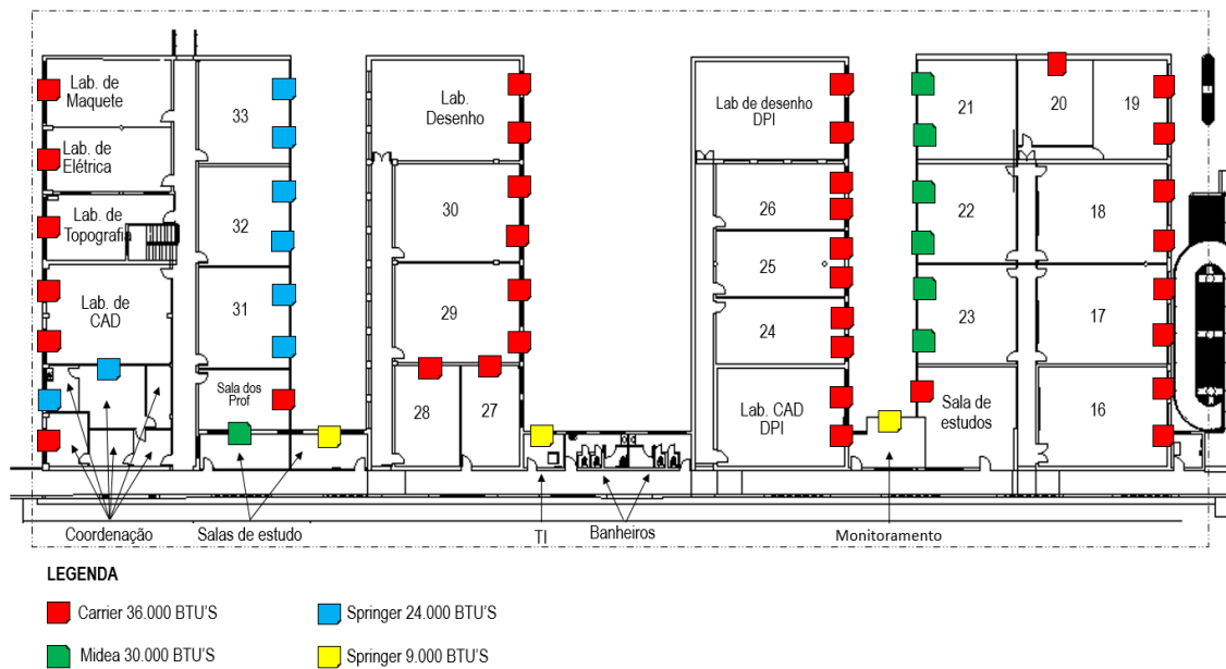
Figura 4: Esquema da localização das máquinas instaladas. Fonte: Elaborada por autores.
