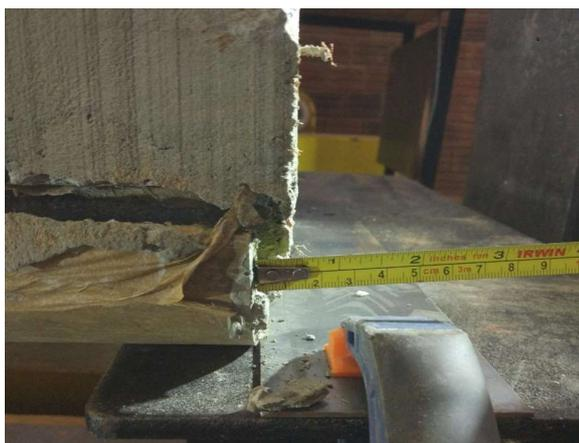
Figura 3 - Ilustração do deslocamento relativo da laje 05. Fonte: autores
