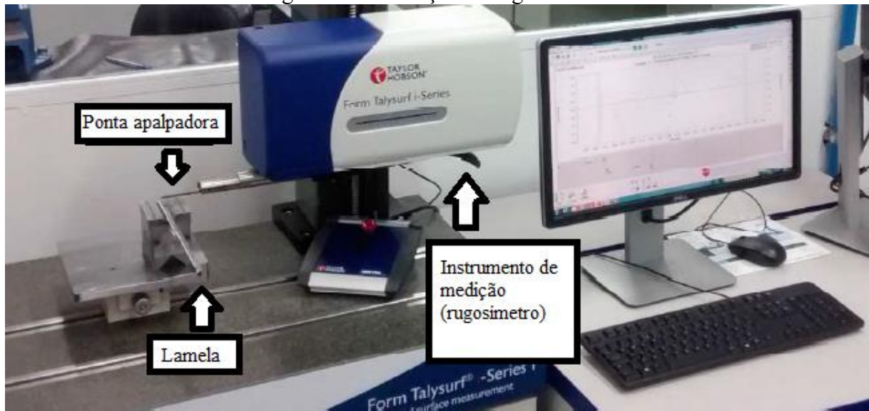
Figura 3.9 – Medição de rugosidade na lamela.
