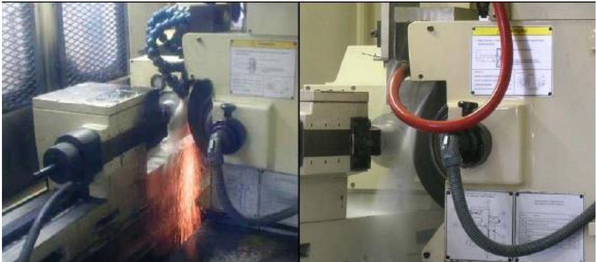
Figura 2.26 – Redução da quantidade de faíscas empregando diferentes sistemas de alimentação de fluido.
