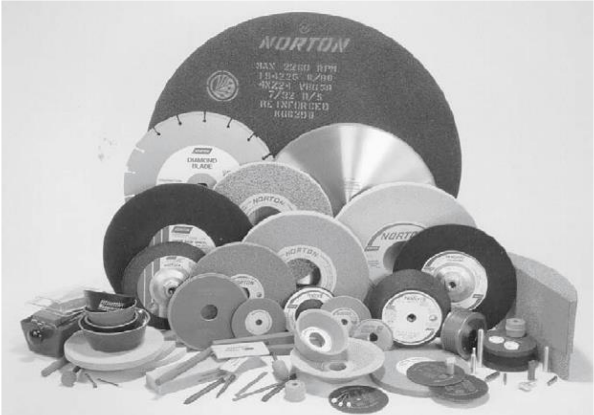
Figura 2.11 – Ferramentas rotativas com grãos abrasivos de geometria não definida.
