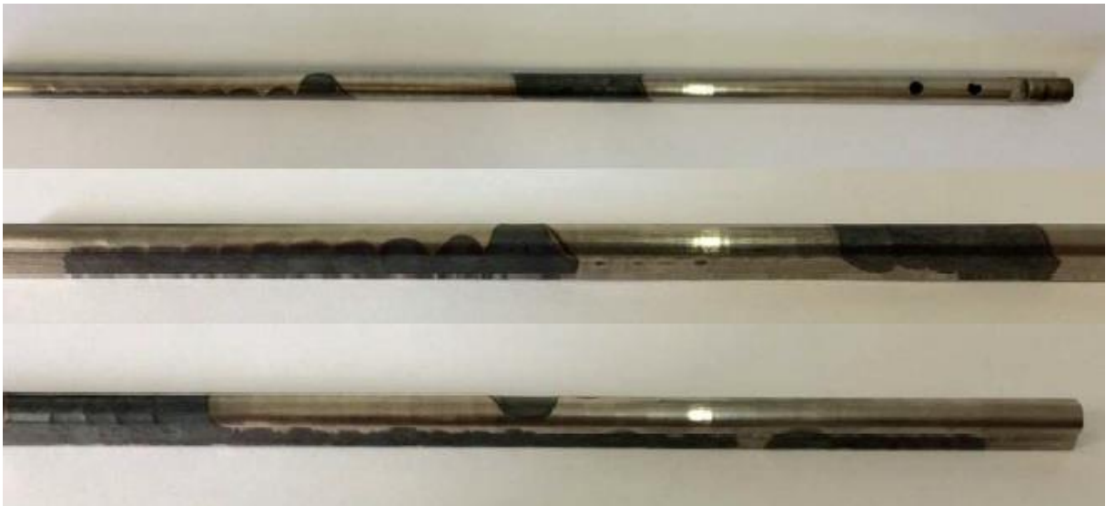
Figura 2.7 - Componente obtido na retificação creep feed com “queima de retificação”.
