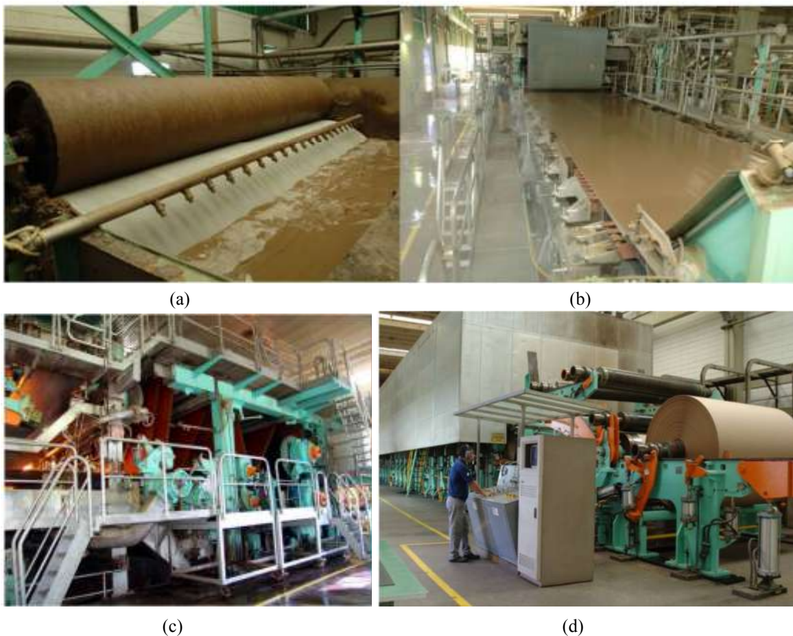
Figura 65 - (a) Preparo da massa, (b) Formação da folha de papel, (c) Prensagem, (d), Acabamento e rebobinamento.
