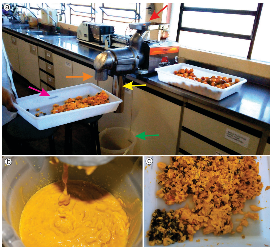
Figura 4: Processo de obtenção de polpa de butiá; a) Despoldadeira utilizada no processo, seta vermelha indicando onde são colocados os frutos, seta laranja, indicando onde saem os resíduos, seta amarela indica o local de saída da polpa e seta verde indica local onde está sendo depositada a polpa; b) resíduos obtidos; c) Polpa obtida no processo. Fonte: elaborado pelos autores.
