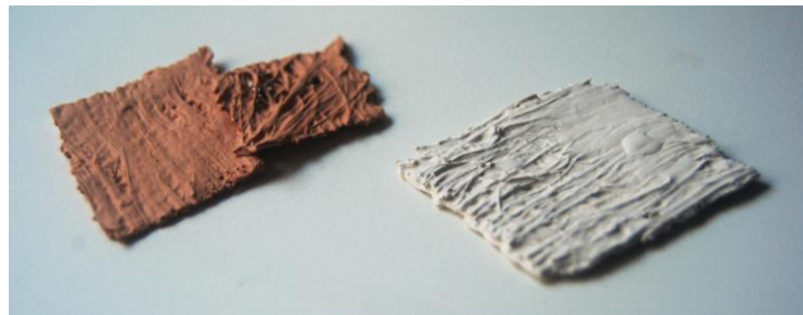
Figura 6: Amostras da fibra de palmeira após ser cozida. Fonte: elaborado pelos autores.
