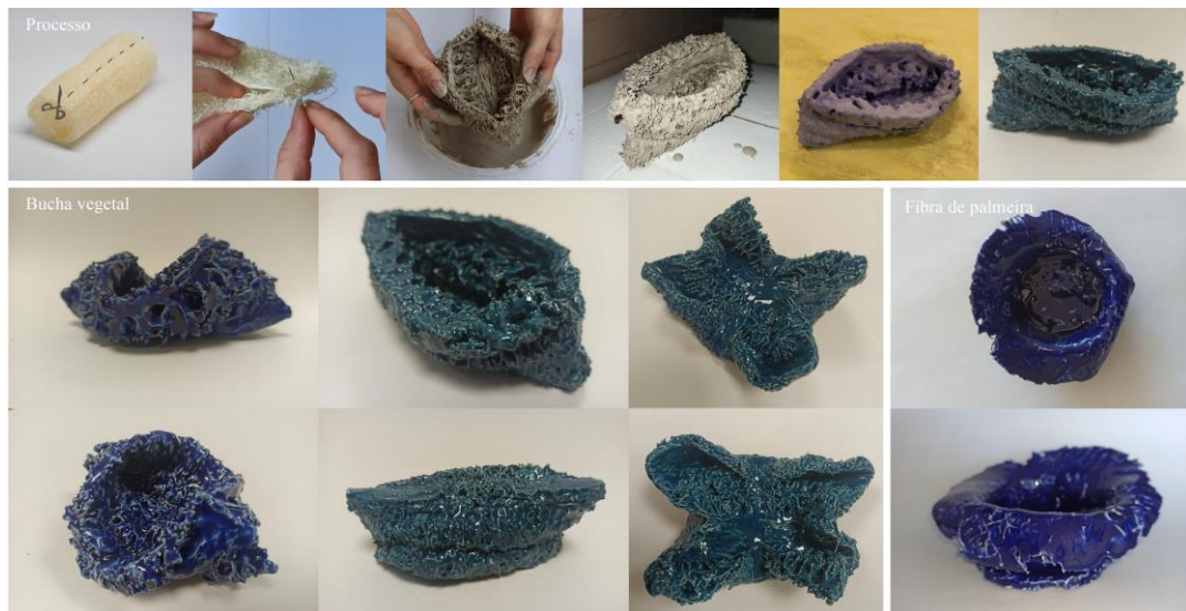
Figura 10: Projeto 3. Utilização da luffa e fibra de palmeira como matriz da peça cerâmica. Fonte: elaborado pelos autores.
