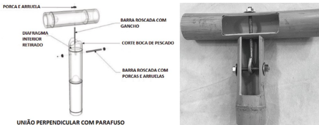
Figura 3 – Ligação com gancho e barra rosca. Fonte: NBR 16828-1 (2020).
