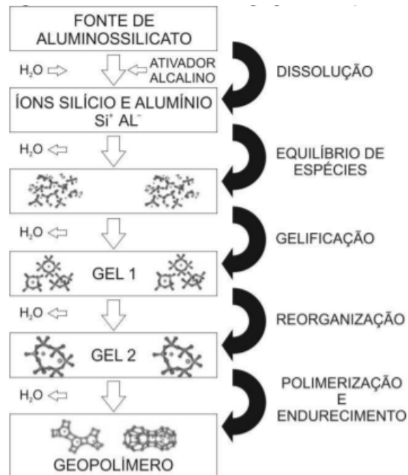
Figura 2- Etapas do processo de geopolimerização.
