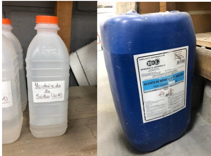
Figura 12- Matérias primas utilizadas para a preparação da solução: a) Hidróxido de Sódio (10M) e b) Silicato de sódio.
