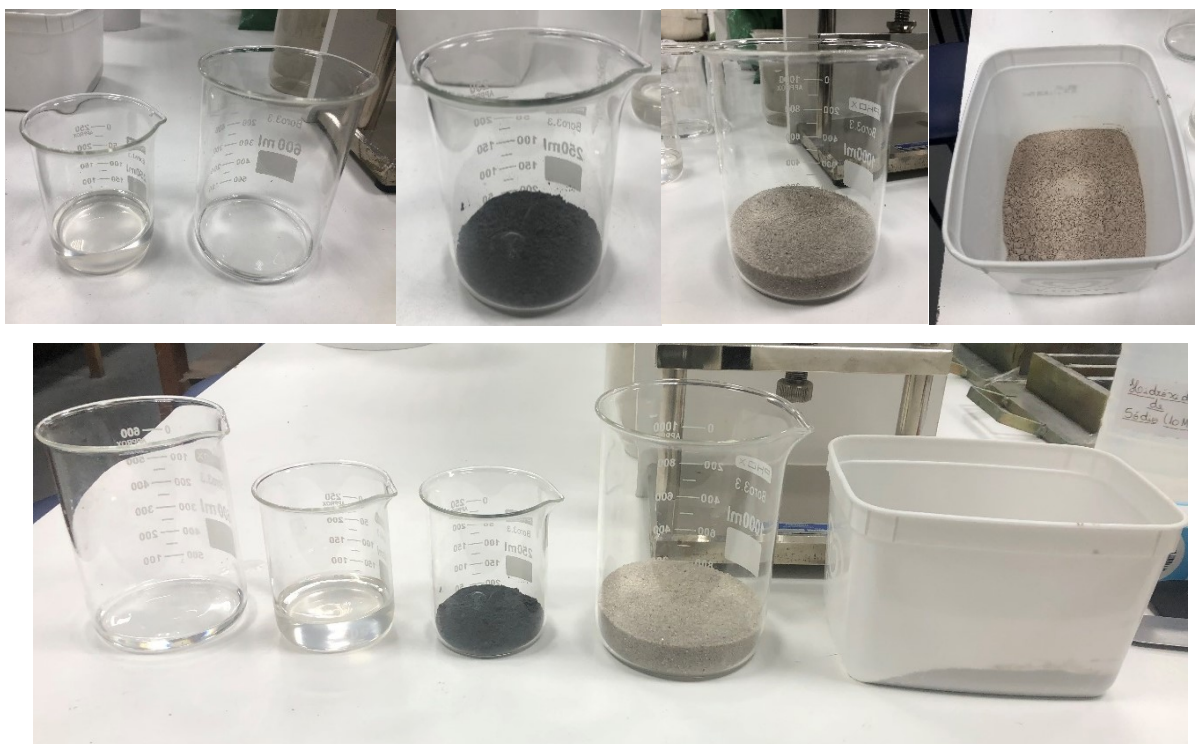
Figura 7- a) Solução hidróxido de sódio 10M ; b) Silicato de sódio; c) Cinza de Casca de Arroz; d) Areia média grossa e e) Metacaulim.
