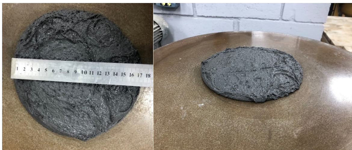
Figura 14- Diâmetro de espalhamento da argamassa geopolimérica de 20% de substituição de SN.
