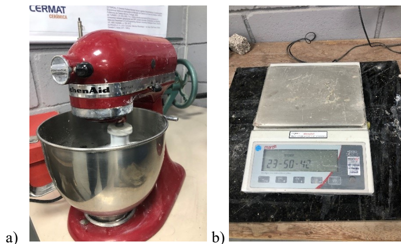
Figura 16- Equipamentos utilizados para a produção das argamassas: a) Misturador mecânico; b) balança de precisão 0,01g ; c) moldes.
