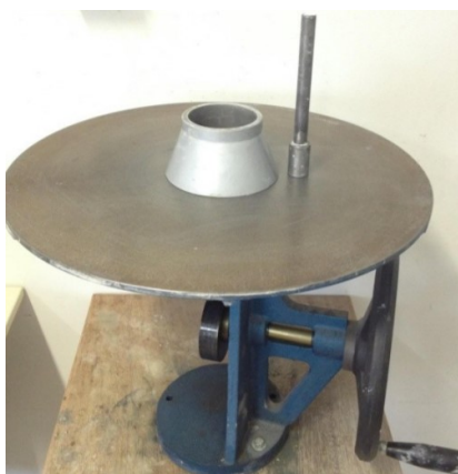
Figura 18- Ensaio de mesa de consistência (Flow Table) realizado no estado fresco.
